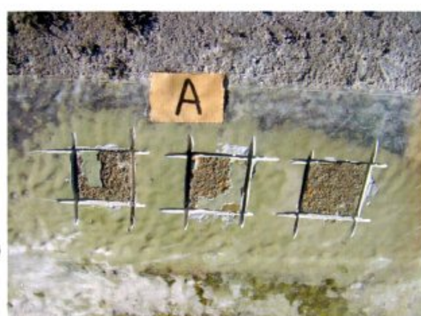
ライニング施工年1987年 19年経過後に外部試験会社による付着強度試験を行う
