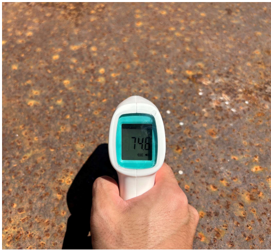
【表面】 左：敷鉄板、右：CLT 敷板
