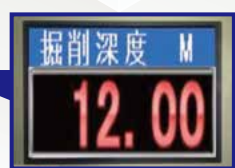
施工状況の外部モニター表示により操縦者に加えダブル管理
