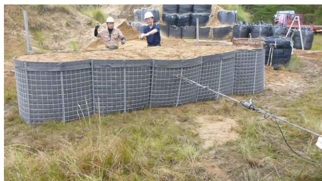
写真-1 変位 50 cmの状況(左:連続箱型鋼製枠, 右:耐候性大型土のう(結束有))
