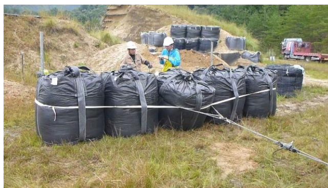
写真-1 変位 50 cmの状況(左:連続箱型鋼製枠, 右:耐候性大型土のう(結束有))
