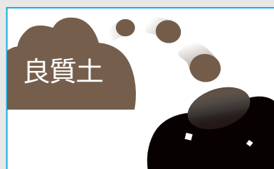
(2) MT 処理土に 良質土を混合する
