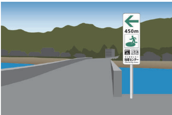
川に架かる橋の手前の道路にポール式の標識を設置した例。
