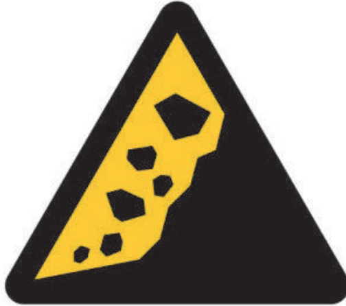
図 E.6—崖崩れ・地滑り避難誘導標識システムに用いる注意図記号
