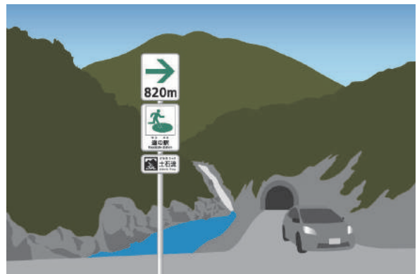
山及び川に挟まれた付近にポール式の標識（補助標識タイプ）を設置した例。
