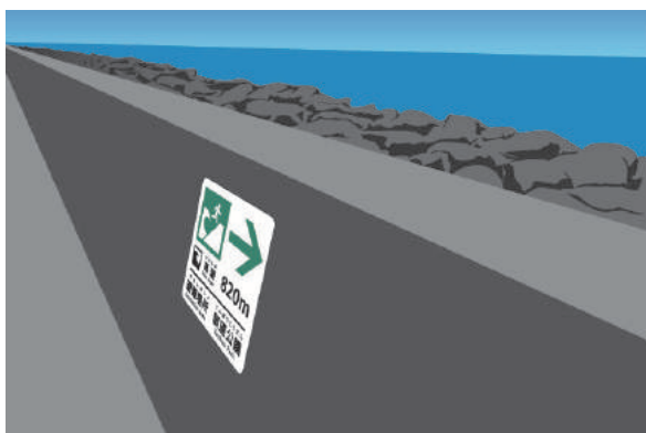
堤防の内側に標識を設置した例。
