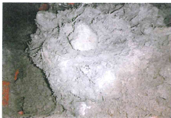
写真－4 チャンバ内に固結した木くず
