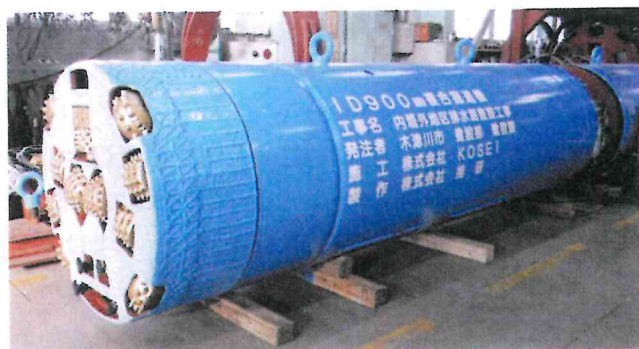
写真-2 CMT改築推進掘進機
