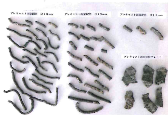
写真－6 排出された鉄筋片と金属片
