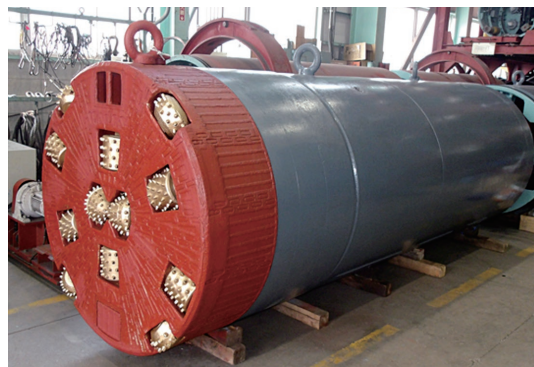
写真-4 CMT工法複合掘進機
