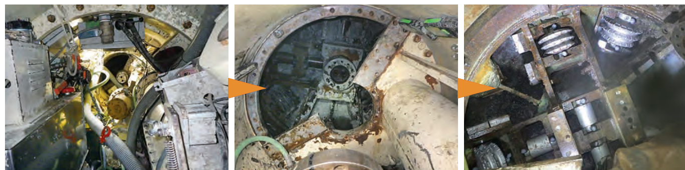
φ1,000mm 機内ビット交換状況
