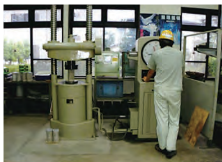
コンクリート圧縮試験
