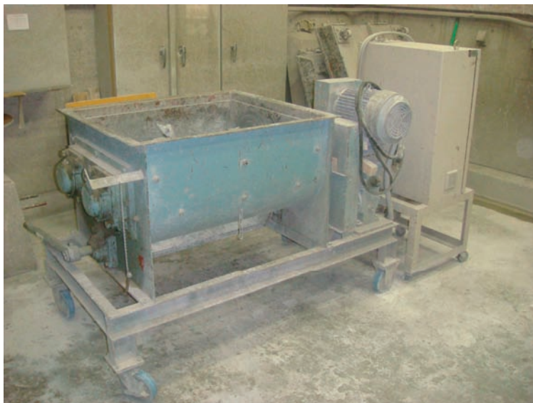
写真－ 4.11 ミキサー例（水平二軸形強制練りミキサ）
