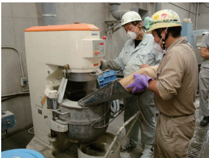
写真－ 4.29 ECC ショット練混ぜ状況一例
