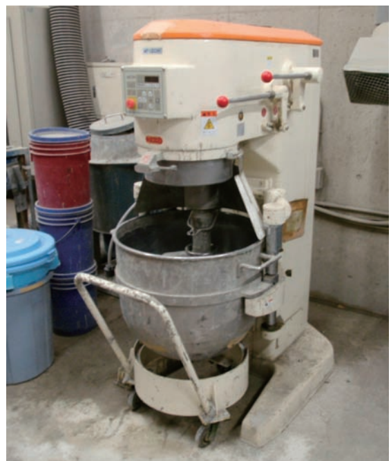
写真－ 4.10 ミキサー例（モルタルミキサ）
