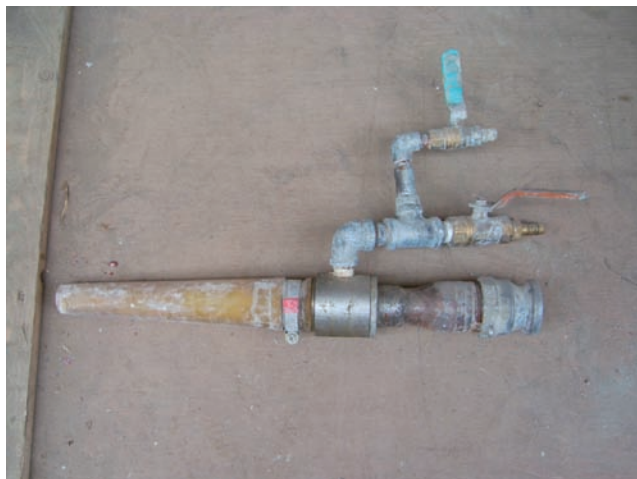
写真－ 4.9 吹付けノズル－例
