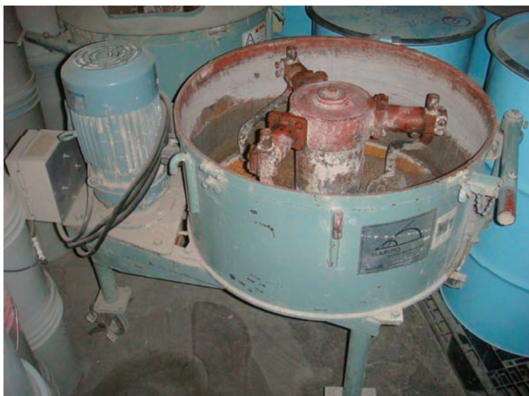
写真－ 4.12 ミキサー例（パン型強制練りミキサ）
