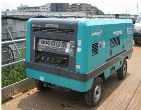
写真一解 2.1.1 エンジンコンプレッサー (100HP) の例
